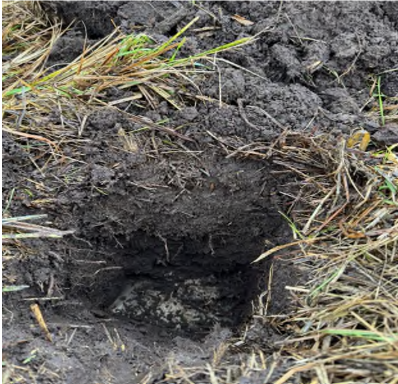
Abbildung 8: oben: Schurf Nr. 1, stark vererdeter Torf bis 35 cm Tiefe, in der Lochsohle sieht man helle Torfmudde, unten: Torfmudde an der Grenze zur Torfauflage
