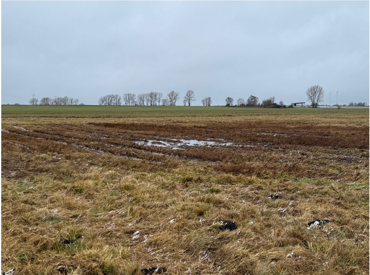
Abbildung 12: Torflinse nördlich der Bahnstrecke von ca. 50 m Ø an den Seggen und dem stehenden Wasser zu erkennen
