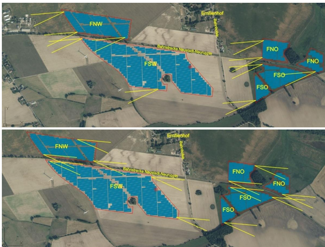
Abbildung 8: Bodennahe Reflexionsrichtungen (gelbe Winkel mit 300 m Schenkellänge) in westliche (oben) und östliche (unten) Richtung, angezeichnet an ausgewählte Eckpunkte der Anlage
