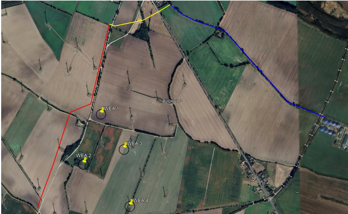
Abbildung 3: Überblick Hochdruckleitungen des NBB und WEA mit Mindestabstand 38,5 m als Kreise
