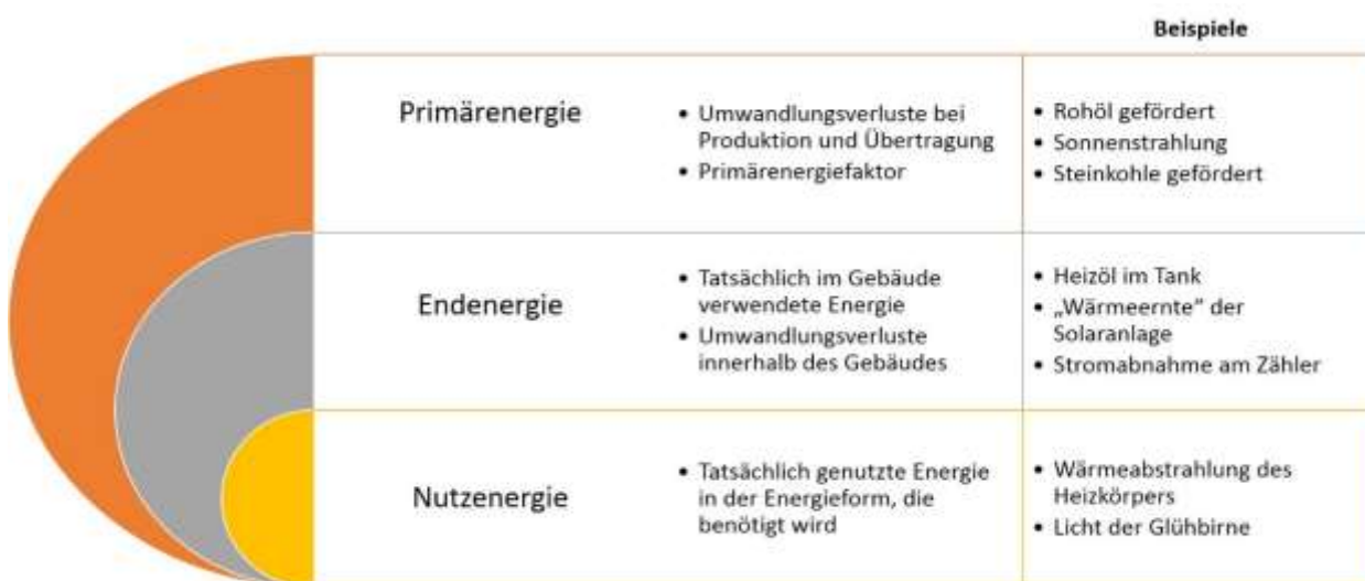
Abbildung 1: Darstellung der Zusammenhänge zwischen den Energieformen zur energetischen Bewertung eines Gebäudes
