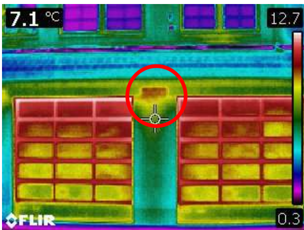
Abbildung 15: Beispiel konstruktive Wärmebrücke
